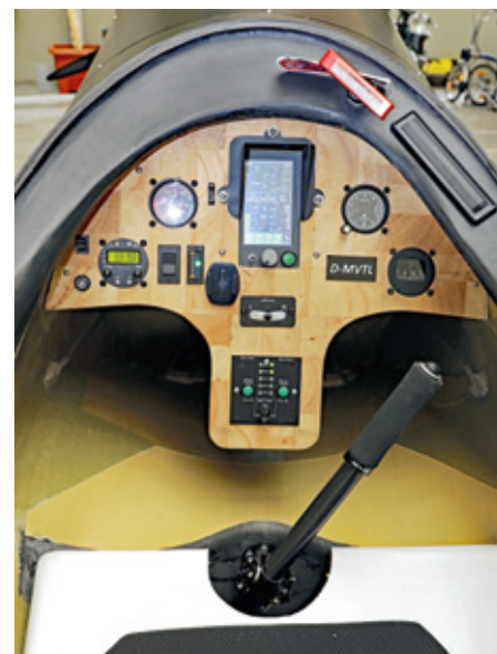
Die Instrumentierung entspricht den Mindestanforderungen für UL und ist ausschließlich unter dem Aspekt der Gewichtsoptimierung zusammengestellt
