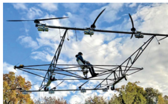
Bemannter Kopterflug – Endphase und Höhepunkt der Schwebegestell-Testreihe
