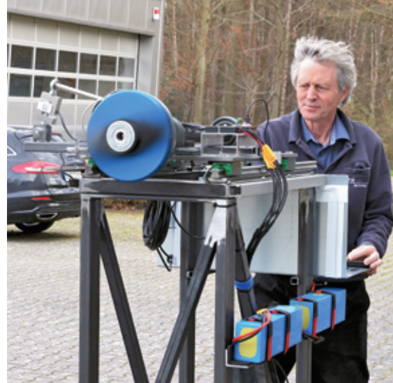
Motorprüfstand für Drehzahl-, Strom-, Drehmoment- und Schubmessung
