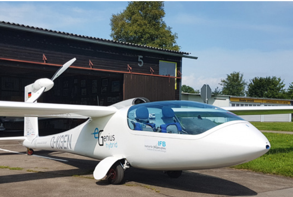
Der e-Genius des Instituts für Flugzeugbau der Uni Stuttgart steht nun auch als Hybridvariante zur Verfügung
