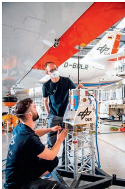
Schwingungserreger am Querruder des ISTAR
