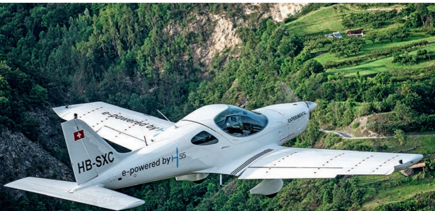
Eine Bristell B23 dient als Versuchsträger für die Elektrifizierung
