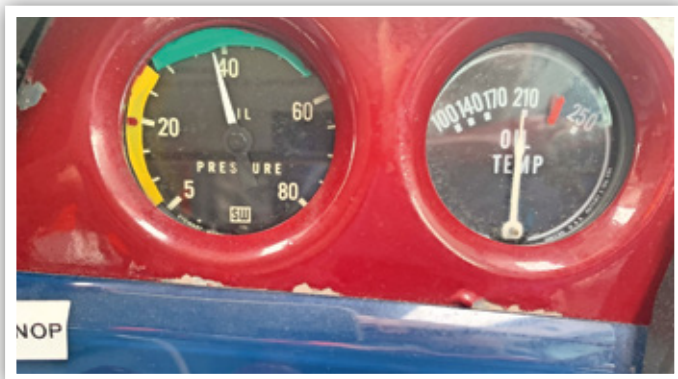
◀ Die Hitze war groß – das über 50 Jahre alte Instrument der C140 zeigte 210 Grad Fahrenheit an. Das bekommt dem Motor nicht auf Dauer
