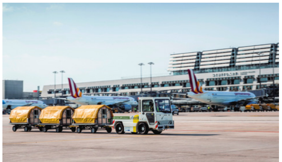
Schon in wenigen Jahren sollen die ersten Gepächtfahrzeuge auf dem Vorfeld des Stuttgarter Flughafens ohne Fahrer unterwegs sein
