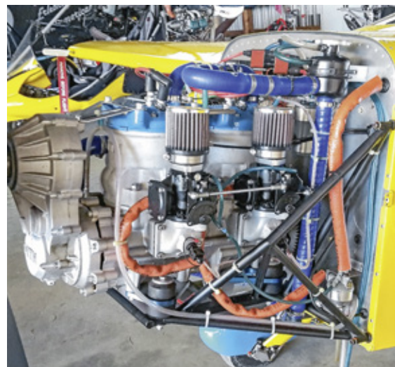
Der Zweitakt-Flugmotor der Rans S9 entstand überwiegend im Eigenbau
