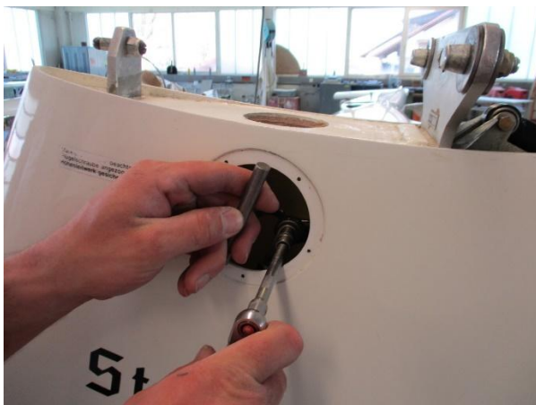
HR-Stange durch Handlochdeckel lösen und mittels Schnur durch die Bohrung nach oben herausnehmen Loosen elevator pusrod through control openings and remove upward through cut hole using a string
