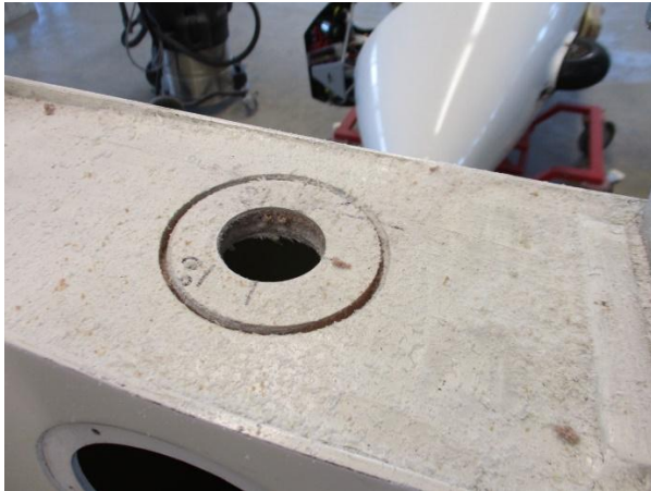
Lochsäge Ø 32 mm – diese kleinere Bohrung komplett durch die Rippe Hole saw (lock saw) Ø 32 mm – this smaller hole cuts through the complete rib
